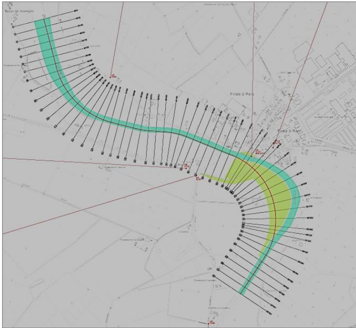
Figura 20 – Planimetria del tratto di idrovia oggetto di rilievo topografico. Sono evidenziate in verde le aree rilevate con piano quotato e le sezioni trasversali estrapolate incrociando il rilievo su campo con rilievo batimetrico
