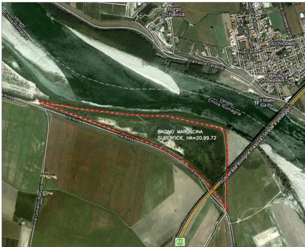
Figura 46 – Il bacino della Maroncina, individuato nell’ambito del Progetto Esecutivo PREGRESSO per il conferimento dei materiali di scavo
