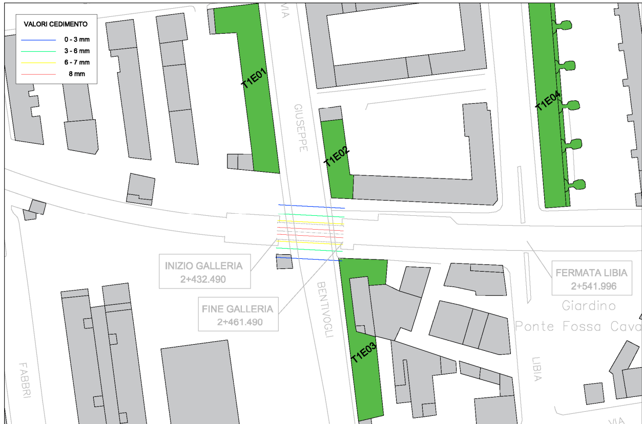
Figura 7: Curve di isocedimento in conseguenza allo scavo della galleria naturale
