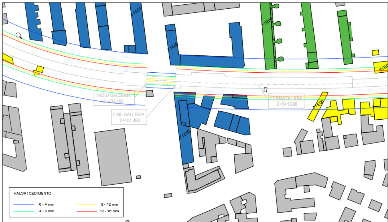
Figura 10: Curve di isocedimento in conseguenza alla realizzazione della galleria artificiale
