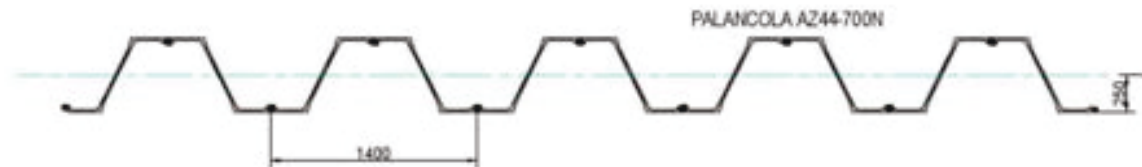
Fig. 5.1 – Sezioni tipiche palancole (con individuazione dell'asse baricentrico)
