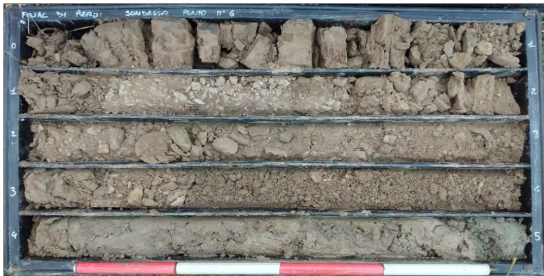
Cassetta 1: da 0.00 a 5.00 m da p.c.
