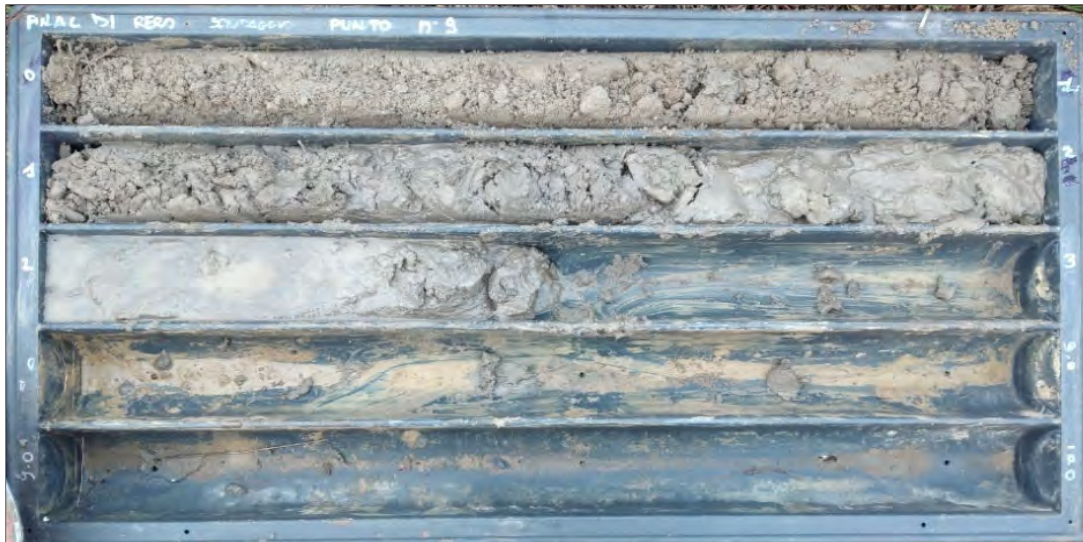
Cassetta 1: da 0.00 a 5.00 m da p.c.
