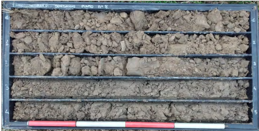
Cassetta 1: da 0.00 a 5.00 m da p.c.
