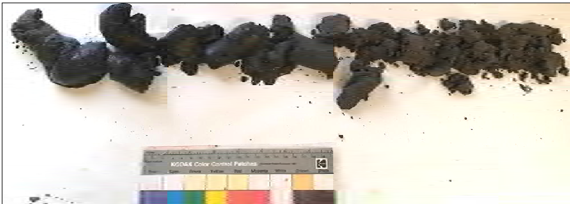
Prelievo C1: da 0.00 a 1.50 m da fondo canale
