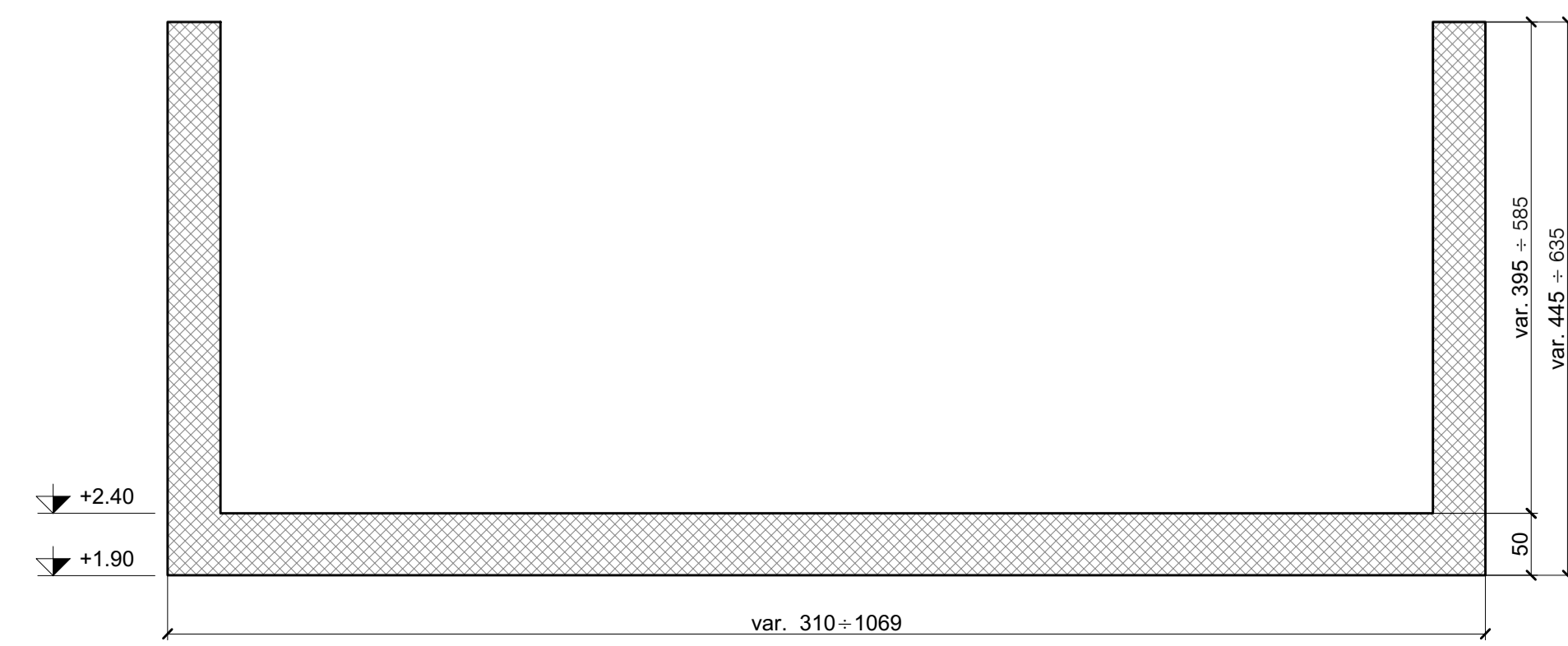
Carpenteria Sezione B-B Imbocco SCALA 1:50
