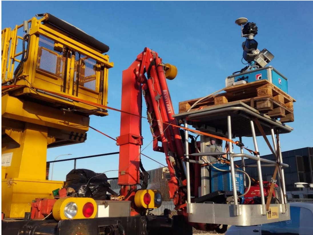
Installazione del MMS Road-Scanner sull'autoscala
