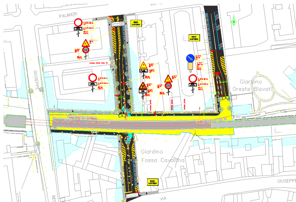
Figura 13: Viabilità di cantiere.
