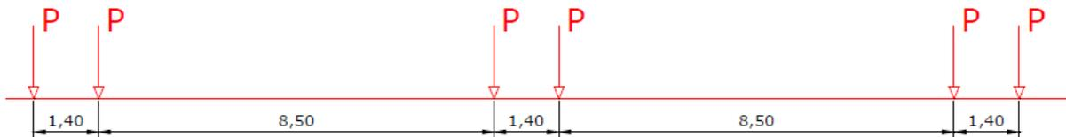
**Figura 44: Schema tram di progetto con masse a pieno carico**
