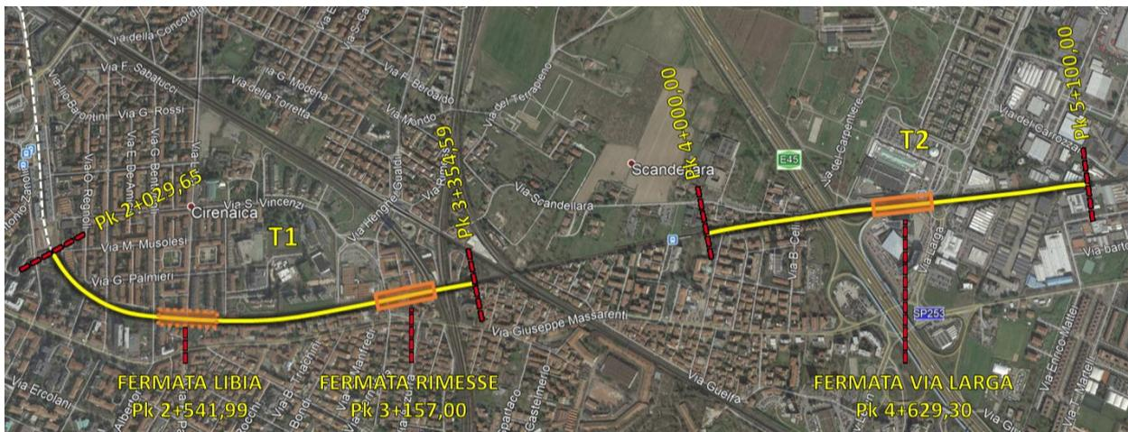
La Tratta T1 (Zanolini-Rimesse) è compresa tra le progressive 2+029,66 e 3+354,59 della linea, e prevede la realizzazione del completamento della galleria di Zanolini, già realizzata, la predisposizione per la nuova fermata Libia e l'adeguamento dell'esistente Fermata Rimesse
