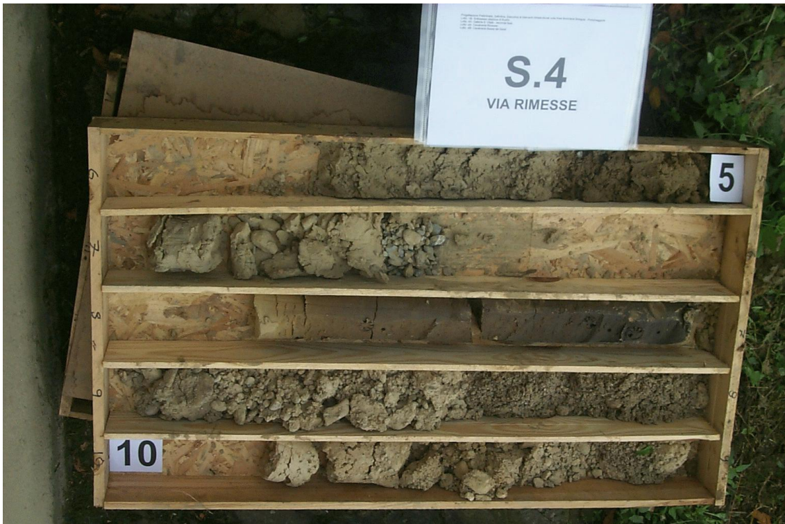
FIG. 3: Sondaggio n° 4. Cassa 2 da -5 a -10 m dal p.c.
