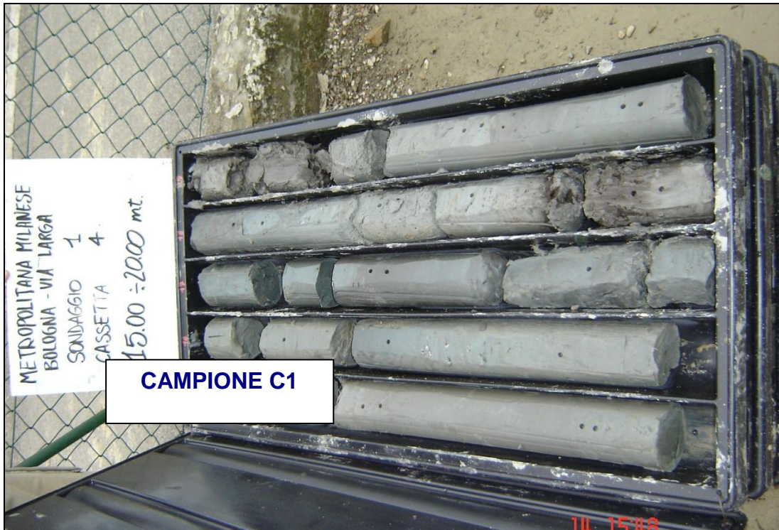
FIG. 5: Sondaggio n° 1. Cassa 4 da -15 a -20 m dal p.c.
