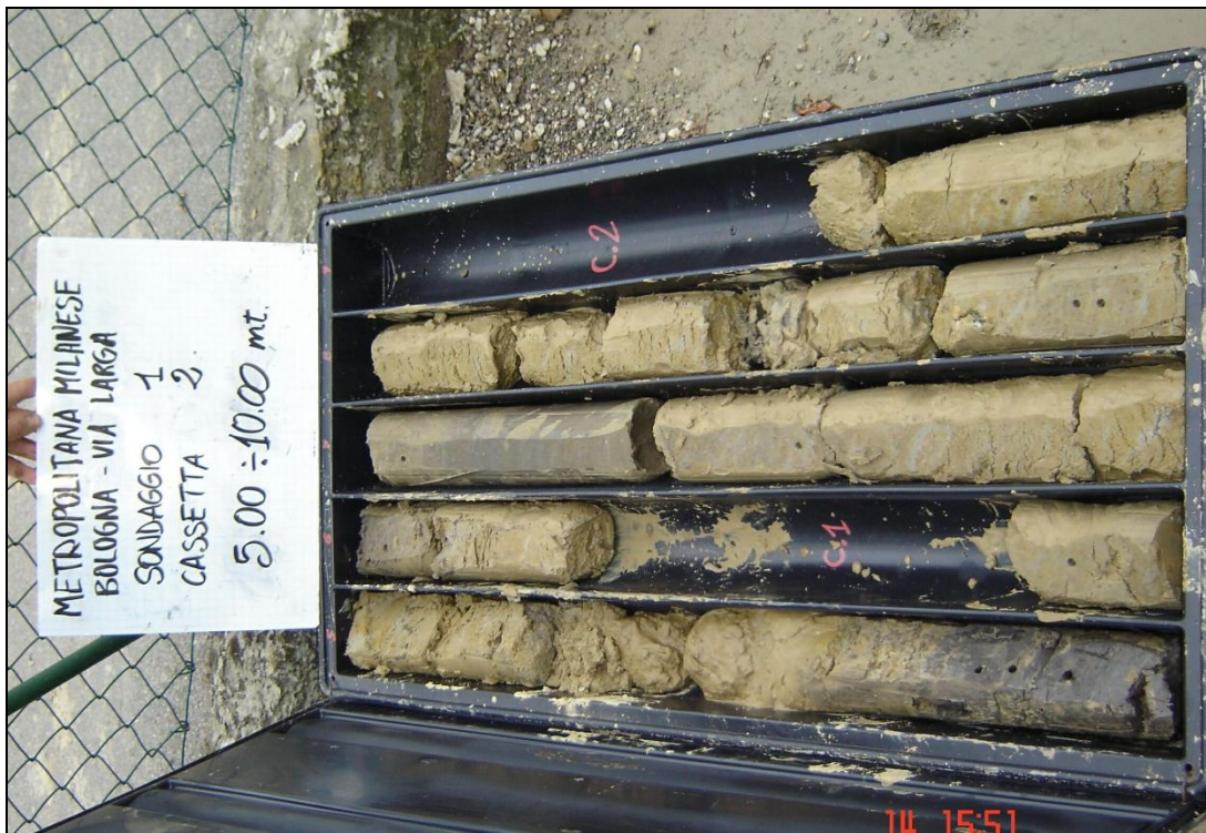
FIG. 3: Sondaggio n° 1. Cassa 2 da -5 a -10 m dal p.c.
