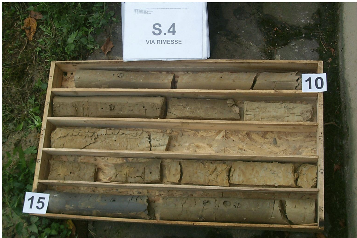
FIG. 4: Sondaggio n° 4. Cassa 3 da -10 a -15 m dal p.c.
