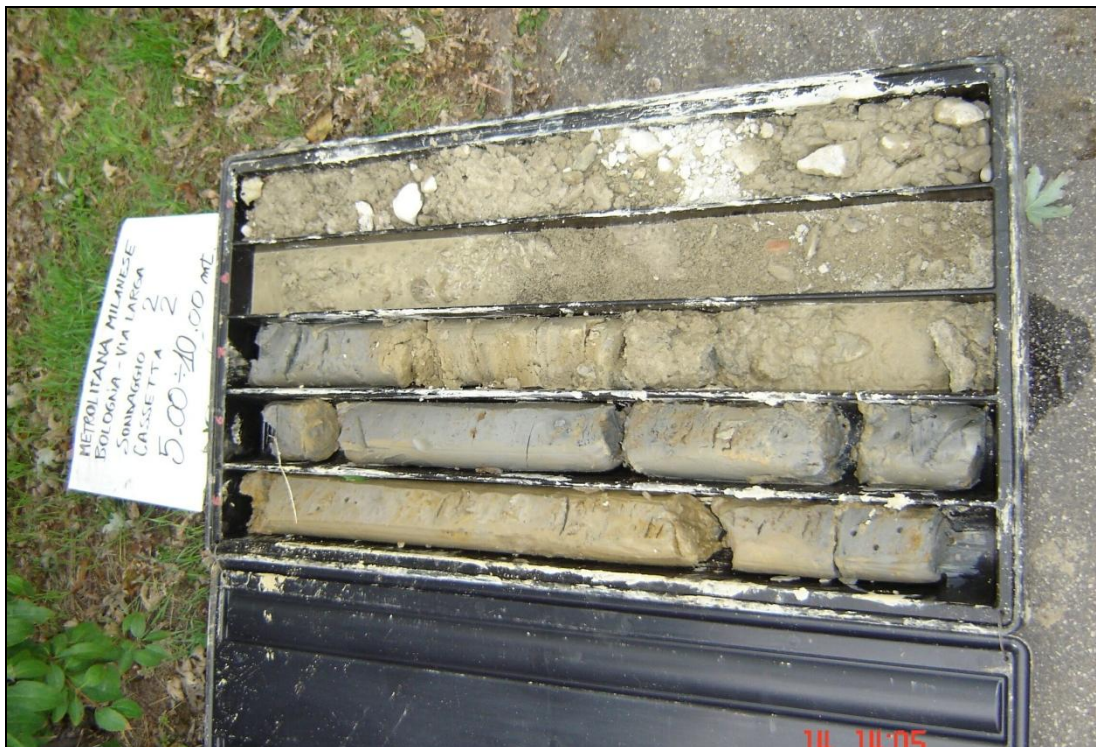
FIG. 7: Sondaggio n° 2. Cassa 2 da -5 a -10 m dal p.c.
