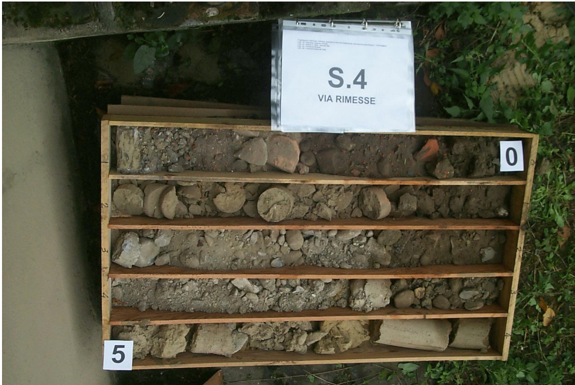
FIG. 2: Sondaggio n° 4. Cassa 1 da 0 a -5 m dal p.c.
