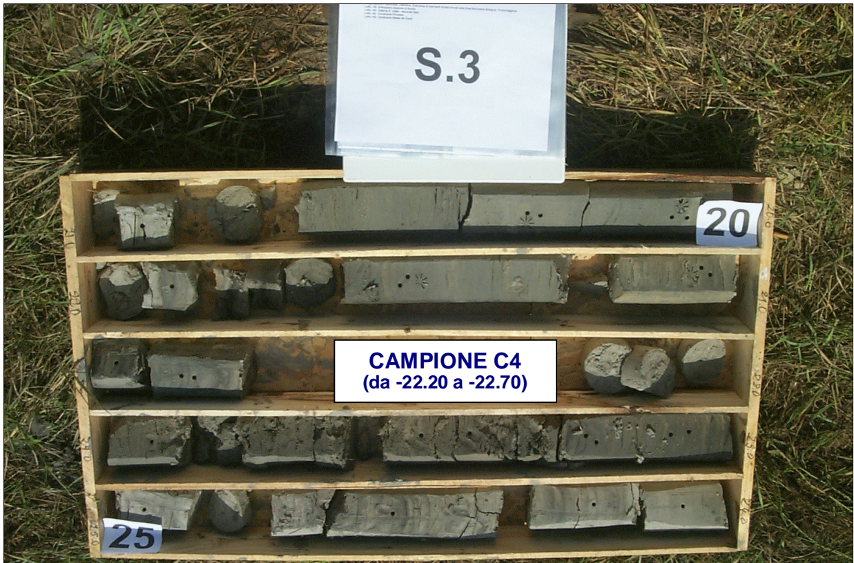
FOTO 20: Sondaggio n° 3. Cassa 5 da -20 a -25 m dal p.c.
