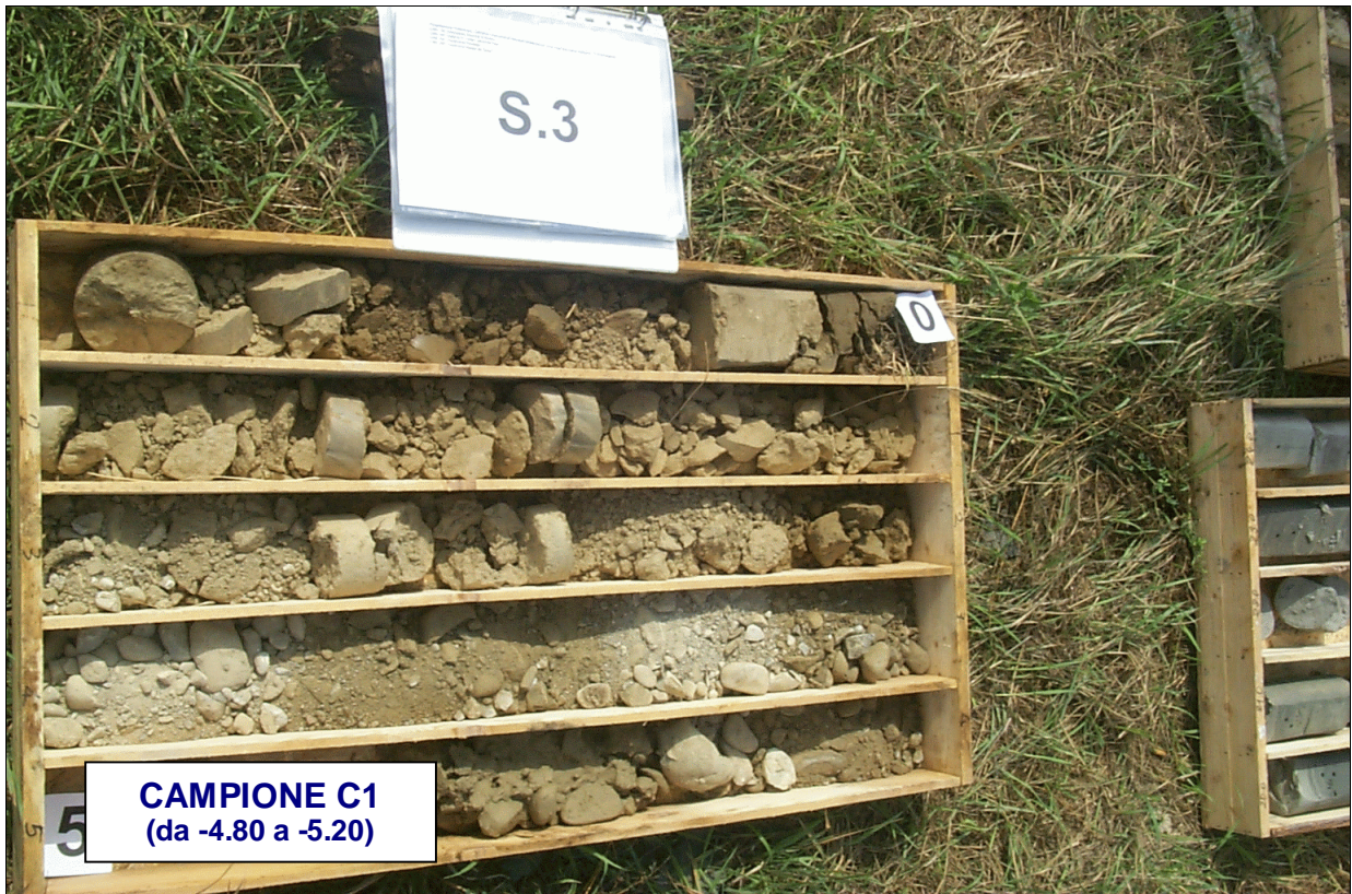
FOTO 16: Sondaggio n° 3. Cassa 1 da 0 a -5 m dal p.c.
