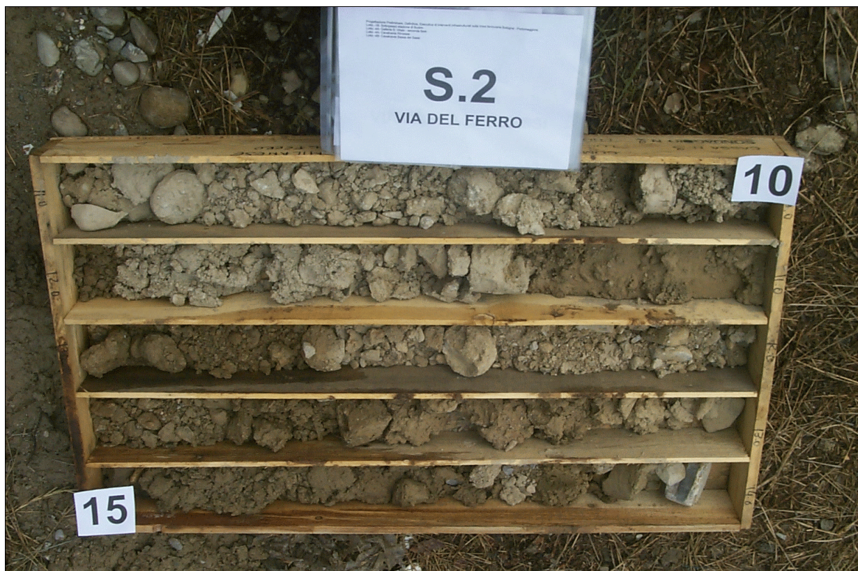
FOTO 11: Sondaggio n° 2. Cassa 3 da -10 a -15 m dal p.c.
