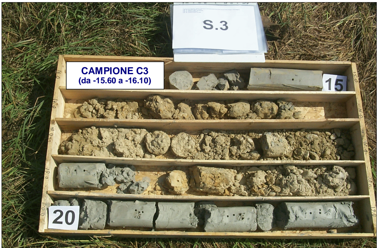
FOTO 19: Sondaggio n° 3. Cassa 4 da -15 a -20 m dal p.c.
