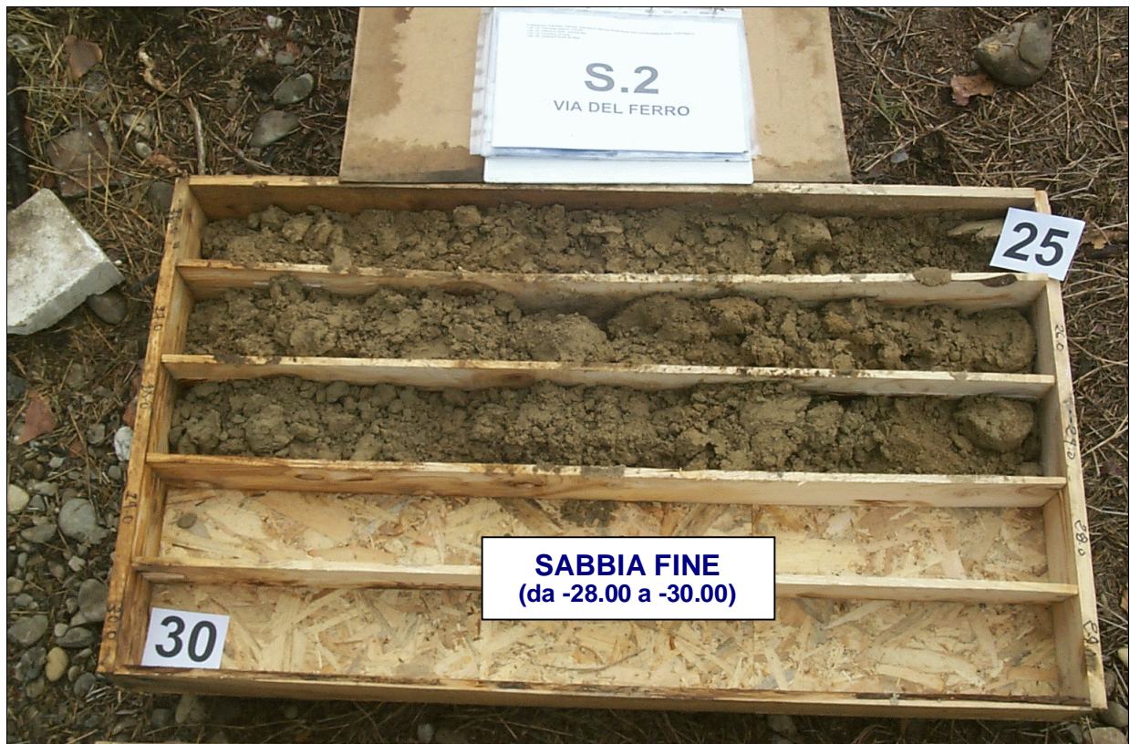
FOTO 14: Sondaggio n° 2. Cassa 4 da -25 a -30 m dal p.c.
