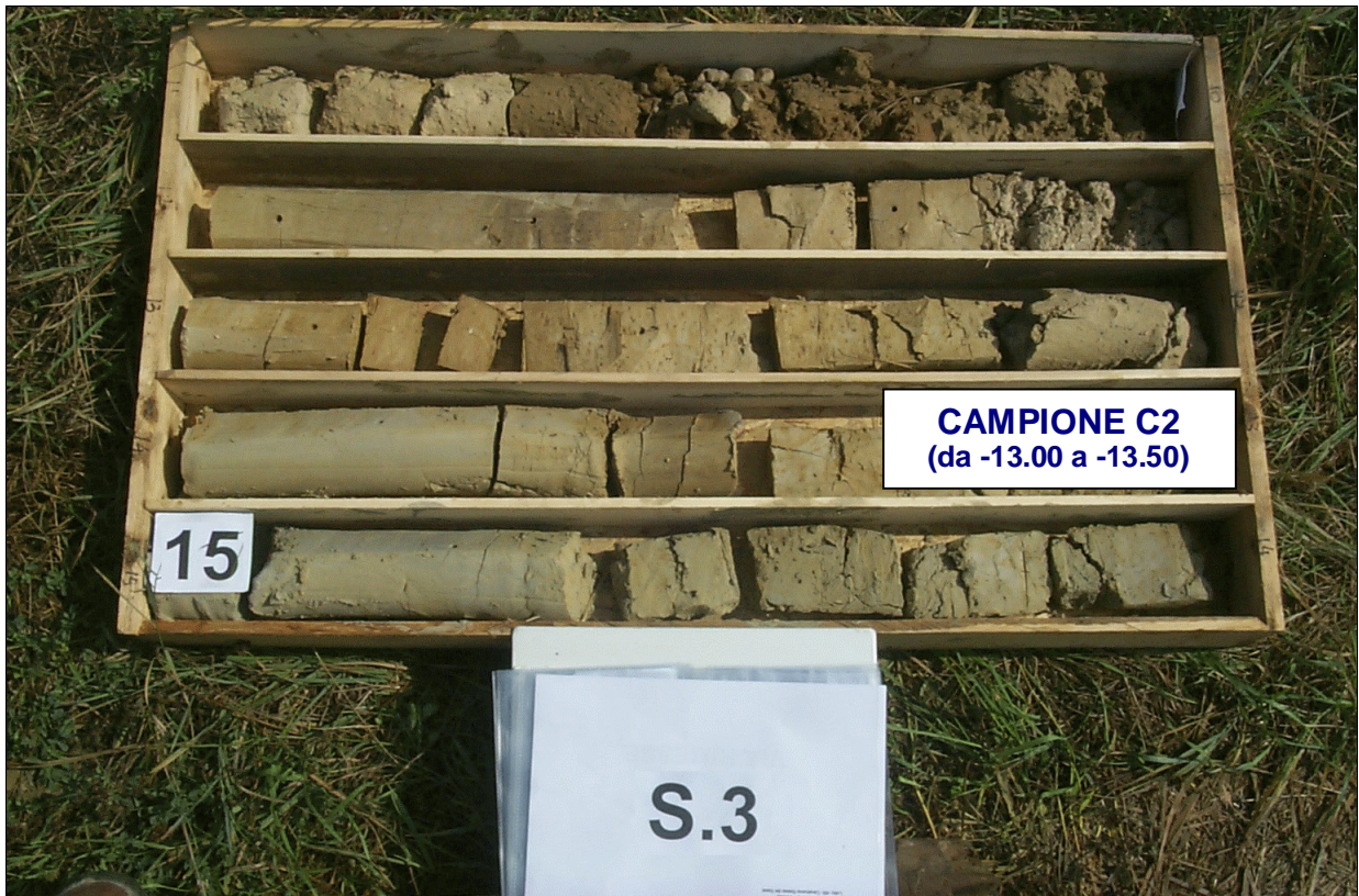
FOTO 18: Sondaggio n° 3. Cassa 3 da -10 a -15 m dal p.c.
