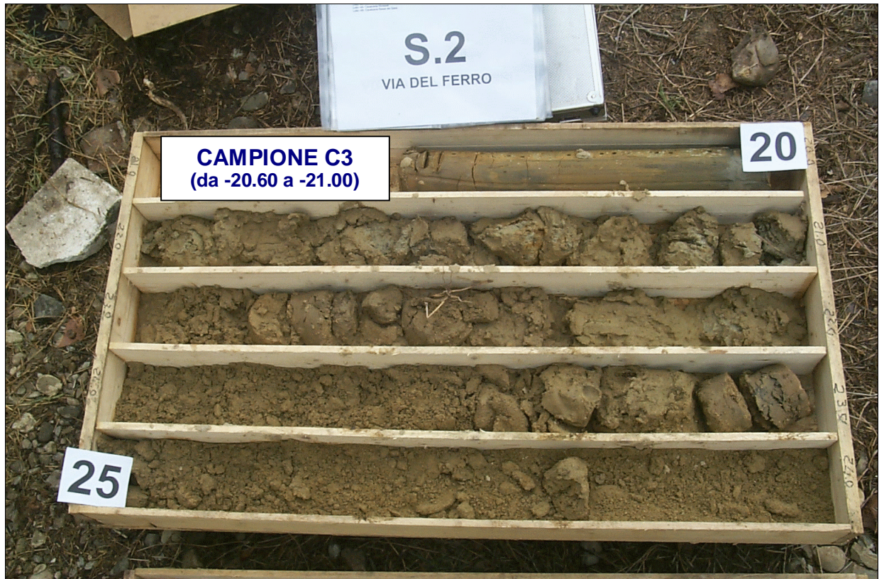
FOTO 13: Sondaggio n° 2. Cassa 4 da -20 a -25 m dal p.c.
