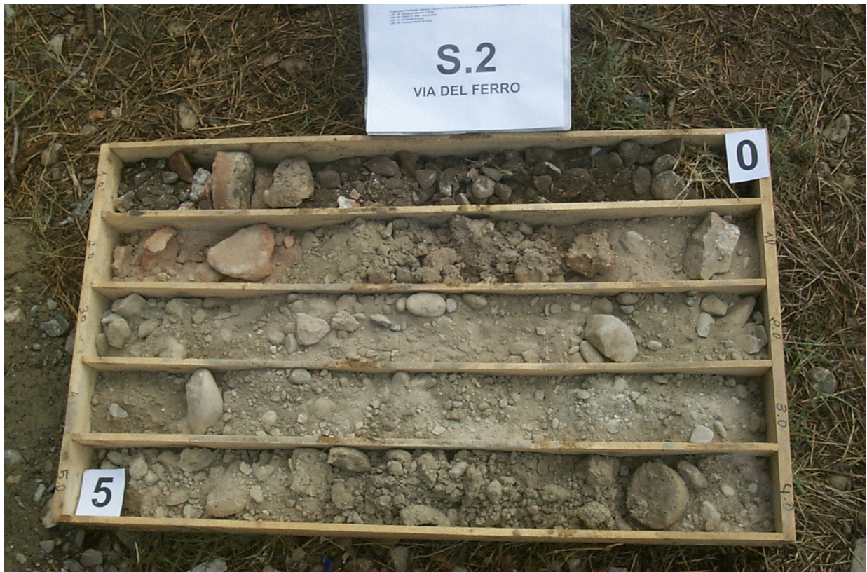
FOTO 9: Sondaggio n° 2. Cassa 1 da 0 a -5 m dal p.c.
