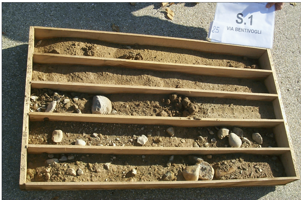
FOTO 6: Sondaggio n° 1. Cassa 5 da -20 a -25 m dal p.c.
