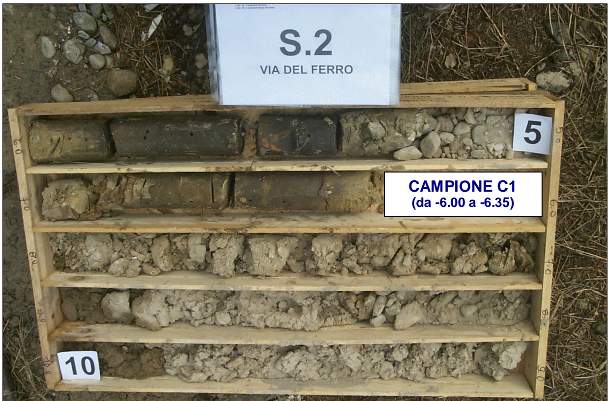
FOTO 10: Sondaggio n° 2. Cassa 2 da -5 a -10 m dal p.c.
