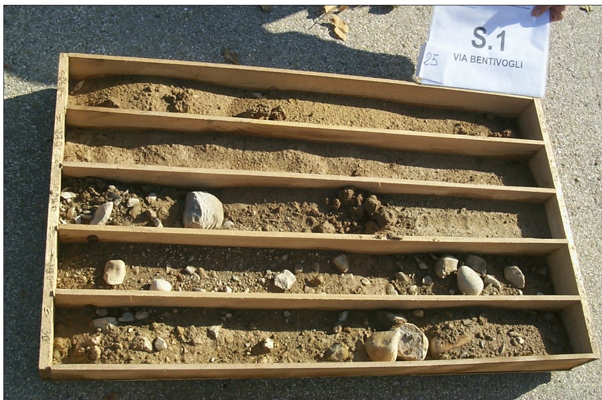
FOTO 7: Sondaggio n° 1. Cassa 6 da -25 a -30 m dal p.c.
