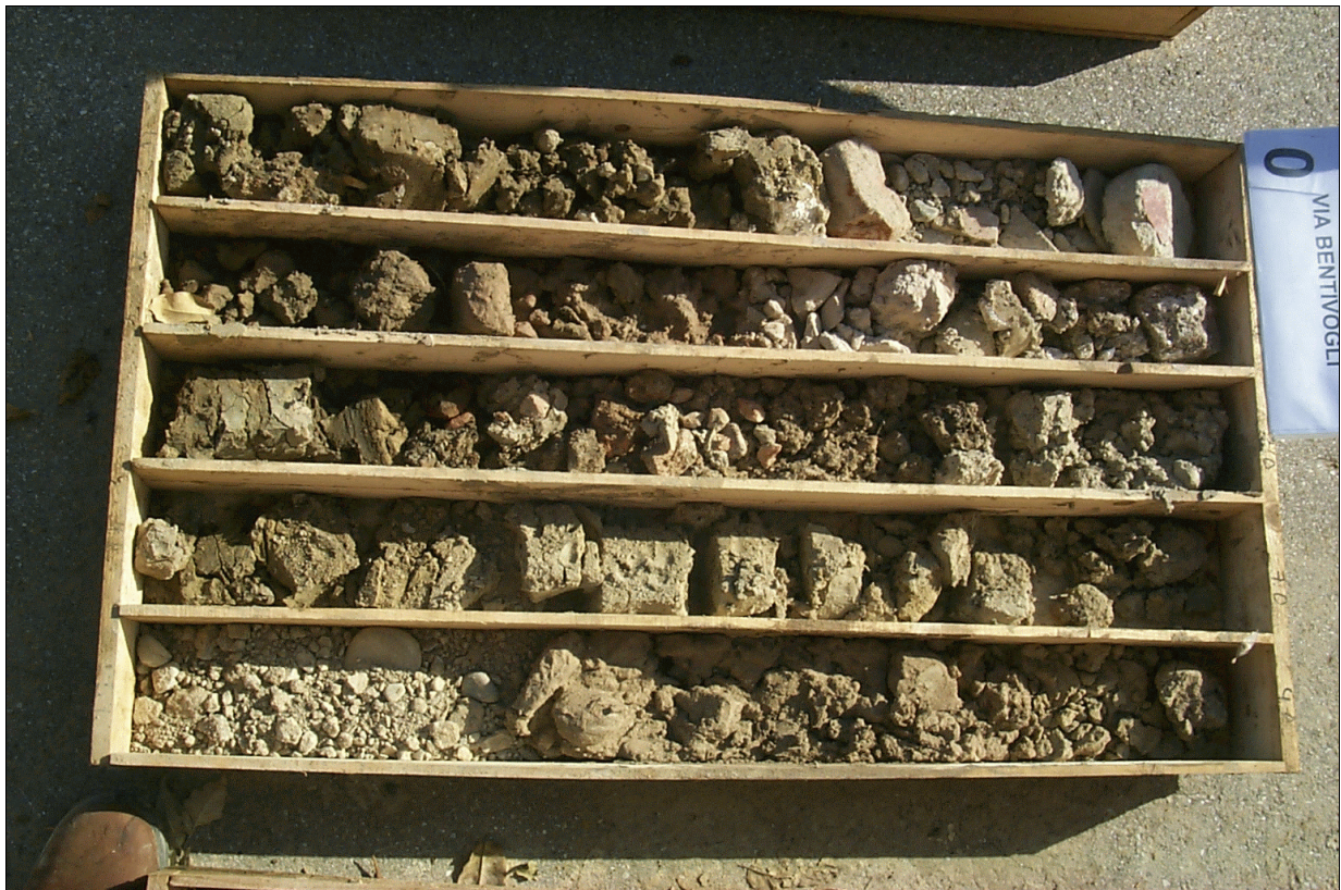
FOTO 2: Sondaggio n° 1. Cassa 1 da 0 a -5 m dal p.c.
