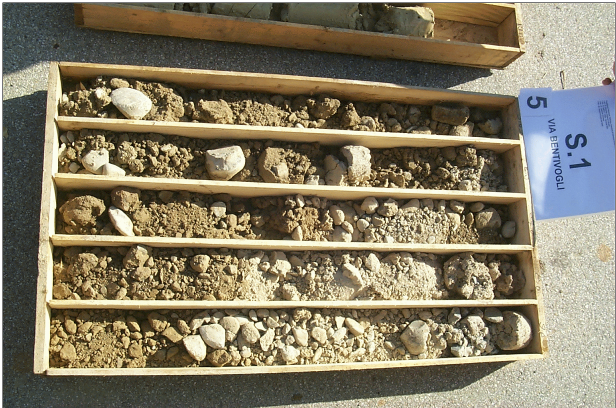
FOTO 3: Sondaggio n° 1. Cassa 2 da -5 a -10 m dal p.c.
