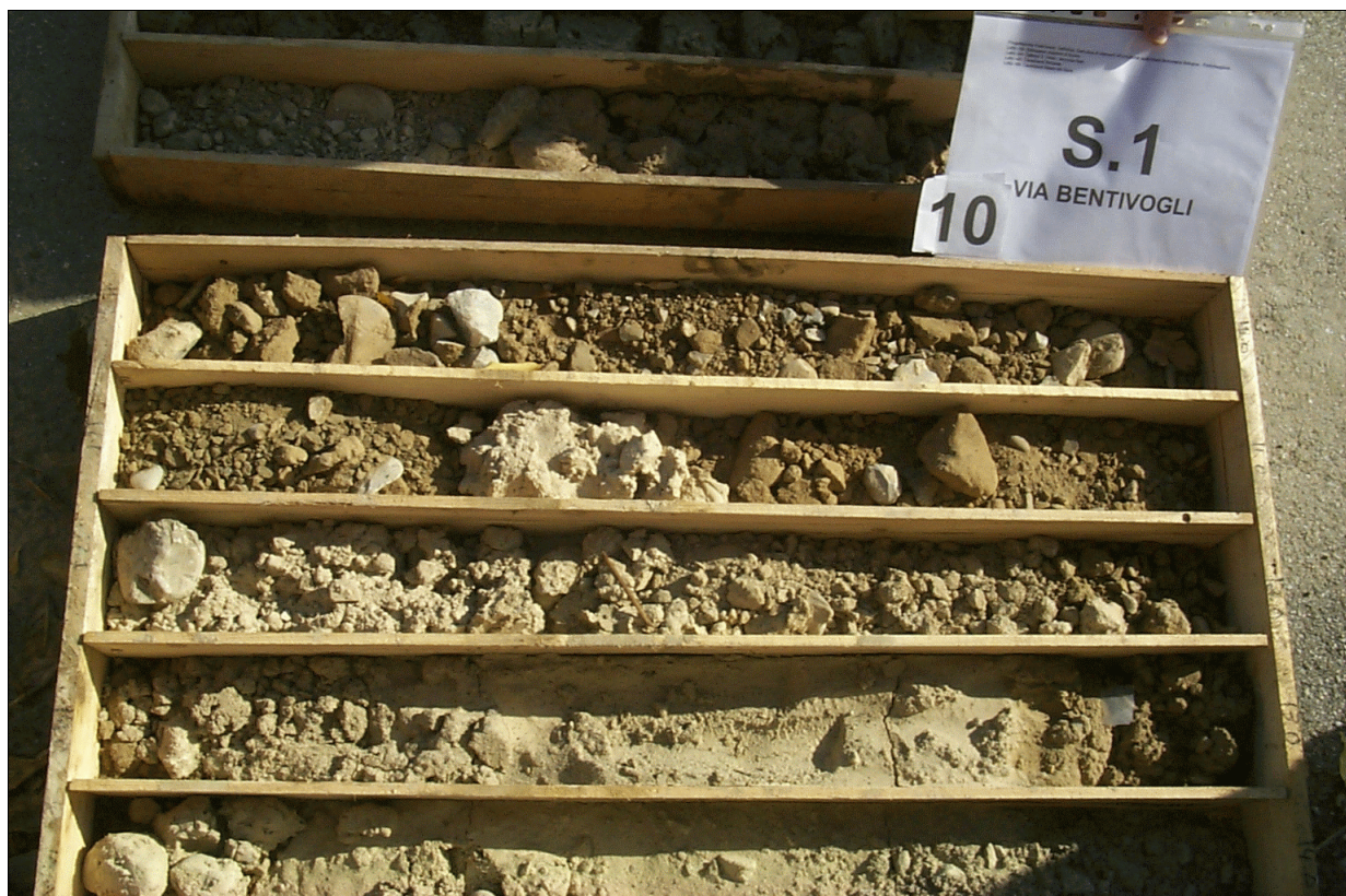
FOTO 4: Sondaggio n° 1. Cassa 3 da -10 a -15 m dal p.c.
