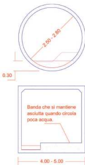
Figura 1.16 - Adattamento di tombini di drenaggio e scatolari idraulici per il passaggio della fauna (tratto da Rivella – UTET Scienze Tecniche) – (da www.arpa.piemonte.it )
