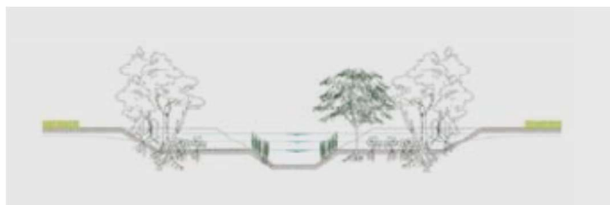
Figura. Esempio schematico di risezionamento di alveo con inserimento di vegetazione su entrambe le sponde.
