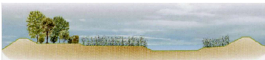
Figura. Esempio schematico di risezionamento con inserimento di vegetazione solo su una sponda.
