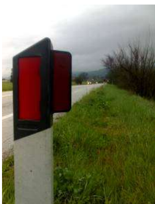
Figura. Esempio di dissuasore riflettente per la fauna selvatica montato su paracarro lungo una strada provinciale.
