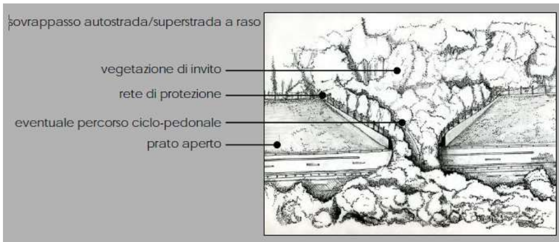
Figura. Esempio schematico di sovrappasso autostradale (da Repertorio sulle misure di mitigazione e compensazione paesistico-ambientale, Milano).
