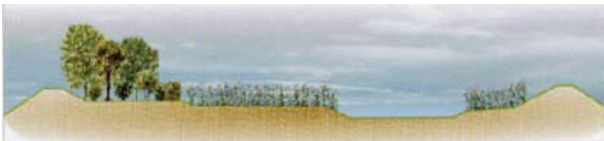
Figura 0.37 - Esempio di risezionamento con inserimento di vegetazione solo su una sponda
