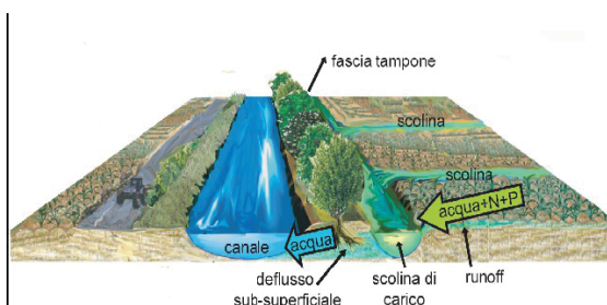
Figura 0.46 - Attraverso la diversificazione della progettazione (solo fasce tampone arboree o in abbinamento con fasce erbacee e scoline di carico) è possibile massimizzare la resa depurativa per diversi tipi di inquinanti (da PTA provincia di Bologna).
