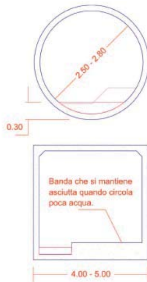
Figura 0.16 - Adattamento di tombini di drenaggio e scotalari idraulici per il passaggio della fauna (tratto da Rivella – UTET Scienze Tecniche) – (da www.arpa.piemonte.it )
