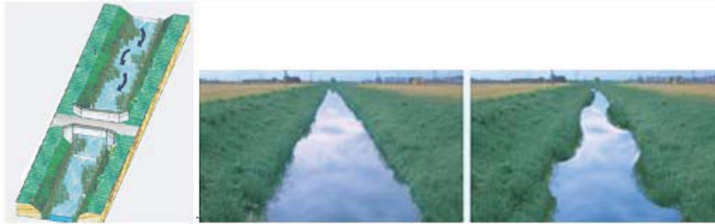
Figura 0.44 - Creazione di canale di corrente sinuoso con l'asportazione parziale della vegetazione erbacea (da PTA provincia di Bologna)
